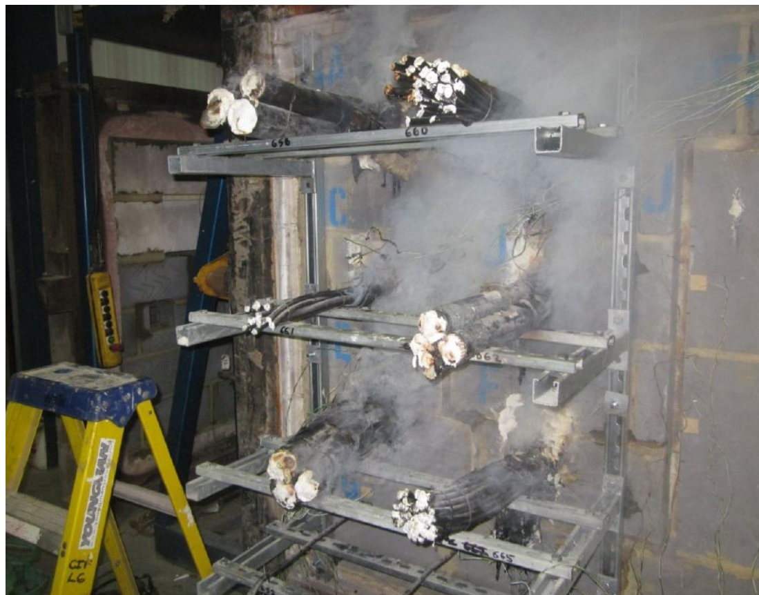
Bilde viser branntest etter 2 timer ved Warringtonfire BMT i Storbritannia
